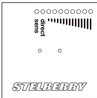
**Регулировка направленности и чувствительности микрофона**
