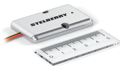
M-65 с АРУ и регулировкой усиления
